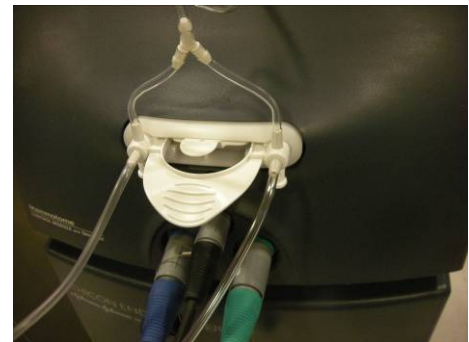
6. Conectar el otro extremo del set de tubos a la unidad principal
